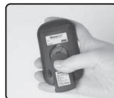
Ihr Glucofine® Blutzucker-Messgerät benötigt 2 Batterien 3V Lithium (CR2032), welche im Lieferumfang enthalten sind. Bitte verwenden Sie nur Batterien vom Typ CR2032 oder gleichwertige Batterien.
