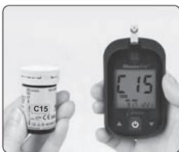
2. Es erkennt die Codierung des Teststreifens automatisch.
