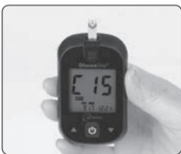
1. Il glucometro Gluceofine® ha una funzione di riconoscimento automatico del codice.
