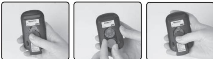
Deux piles 3V Lithium (type CR2032) sont nécessaires. Elles sont comprises dans le kit de l'appareil. Veuillez n'utiliser que des piles du type CR2032 ou similaires.
