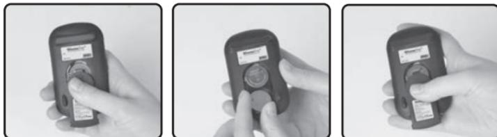
Il glucometro Glucofine® utilizza soltanto le batterie al litio da 3V (CR2032) che sono incluse nella confezione. Quando si sostituiscono le batterie si devono utilizzare solo batterie CR2032 o equivalenti batterie al litio.
